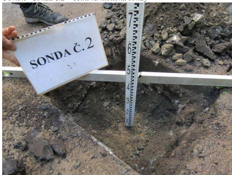
Obr.4.F Sonda č.2 – materiál konstrukční vrstvy
