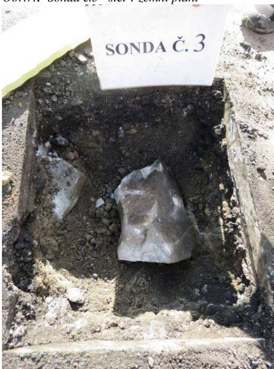
Obr.7.F Sonda č.3 –štět v zemní pláni
