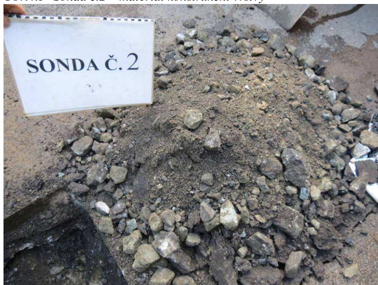
Obr.4.F Sonda č.2 – materiál konstrukční vrstvy
