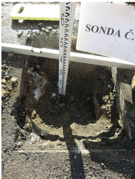
Obr.7.F Sonda č.3 –štět v zemní pláni
