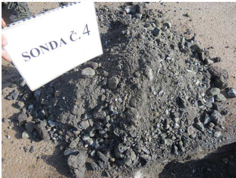
Obr.9.F Sonda č.4 – materiál konstrukční vrstvy
