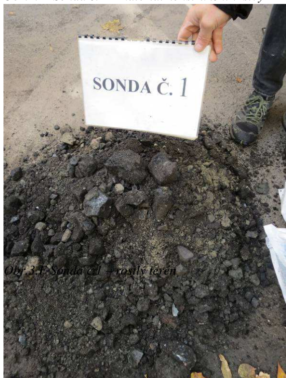
Obr.2.F Sonda č.1 – materiál konstrukční vrstvy
